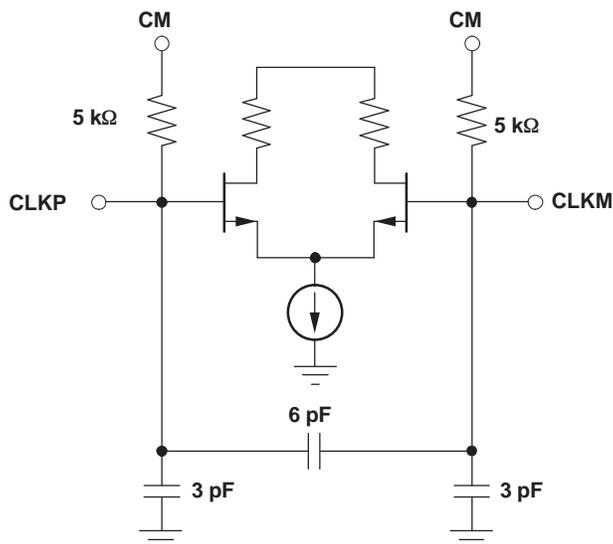
**Figure 45. Clock Inputs**
