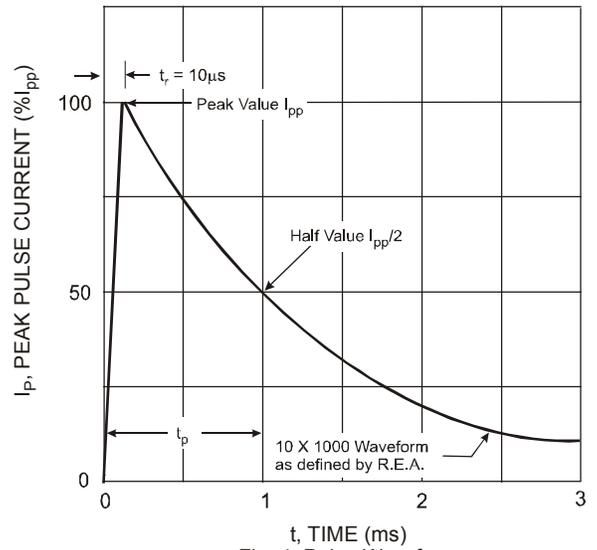
Fig. 4 Pulse Waveform
