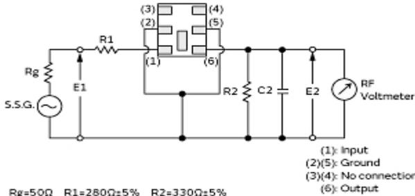
R<sub>g</sub>=50Ω R<sub>1</sub>=280Ω±5% R<sub>2</sub>=330Ω±5%
