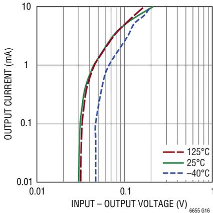
**2.5V Minimum  $V_{IN} - V_{OUT}$
