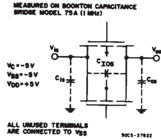
Fig. 24 - Capacitance  $C_{IOs}$  and  $C_{Os}$ .
