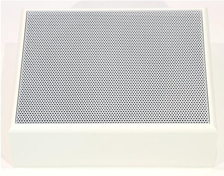
**Wandlautsprecher** mit weißem Kunststoffgehäuse und Lochblech-Abdeckung. Bestückt mit zwei Breitbandlautsprechern und zwei 100-V-Übertragern für eine platzsparende A/B-Verkabelung nach DIN EN 60849/VDE 0828 und VDE 0833-4. Klare Sprachverständlichkeit. Anschluss an das 100-V-Netz und Pegelanpassung durch Schraubklemmen.
