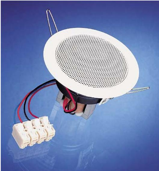
**8 cm (3,3") Deckenlautsprecher** mit weiß lackierter Metallabdeckung (RAL 9010). Geeignet für den Einbau in Unterdecken aller Materialien. Rationelle Montage in kreisrundem Lochausschnitt mit Federbügeln, elektrische Verbindung mit Druckfederklemme. Platzsparende und gut klingende Lösung für den professionellen und den Heimbereich. Durch kleinere Schwingspule höherer Schalldruckpegel.
