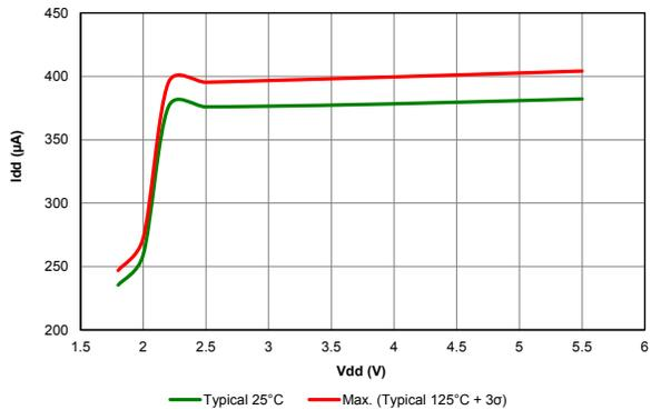
Figure 40-40. I<sub>DD</sub>, ECH OSCILLATOR, TYPICAL
